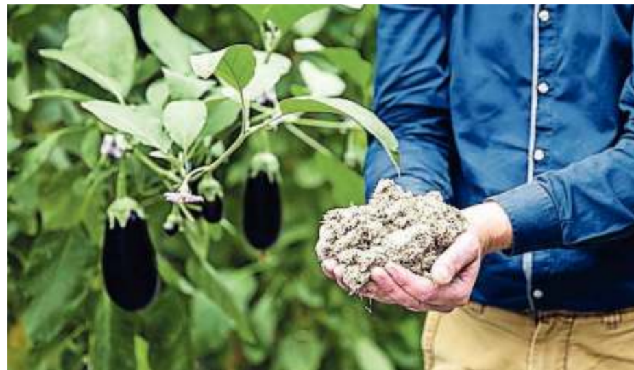
Vermengd met twee minerale grondstoffen leveren de auberginevezels een stabiel plaatmateriaal.
